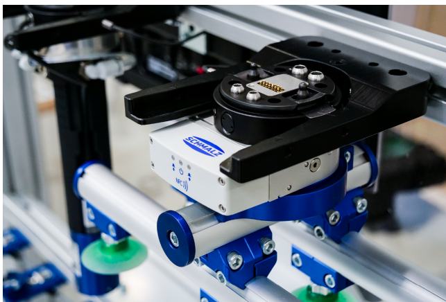
Générateur de vide pneumatique RECBi MATCH lors de la manipulation d'emballages en carton
